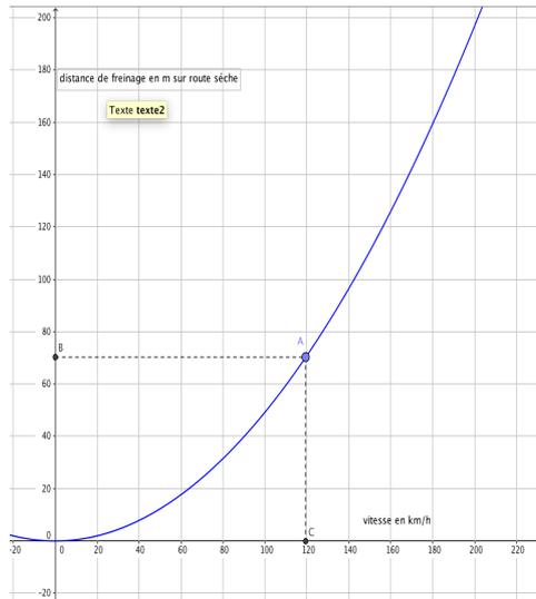
2. D'après la courbe, à 120 km/h la distance de freinage  $D_f = 70\text{ m}$
